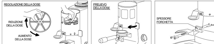
Per centrare la caduta del caffè nel portafiltro è possibile spostare lateralmente la forchetta di supporto sfruttando i due fori che consentono il miglior posizionamento. Se necessario, utilizzare gli appositi spessori (inseriti nella confezione) per arretrare la posizione della forchetta. Una volta trovata la posizione ottimale fissare la forchetta con le relative viti.
