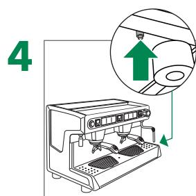
4 Premere il tasto rosso del termostato di sicurezza della caldaia a vapore
