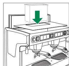
3 Posizionare e fissare il piano scaldatazze
