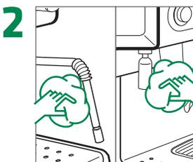
**2** Pulire la lancia vapore/erogatore acqua calda
